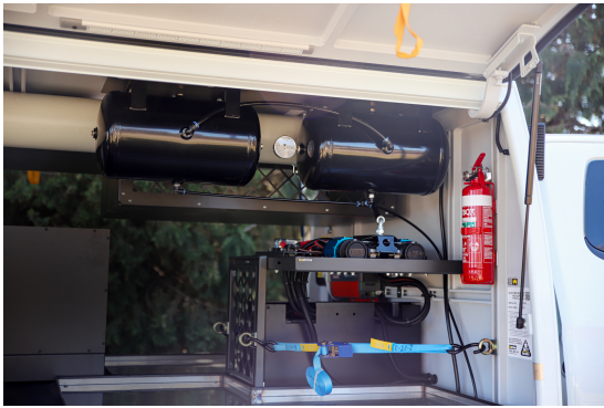
AUX. AIR TANKS 18L AUX Air tank
